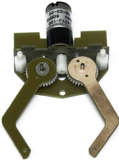
Zdj. 18 Prawidłowo zamontowane ramion
